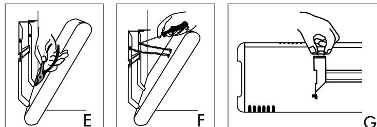
**Figur F** Om radiatorn är utrustad med säkerhetskedja (B4) träs kedjorna över tapparna på väggfästet.
